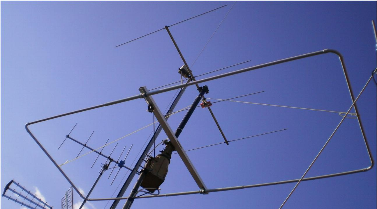
La foto mostra tre pali: non fate caso a quello che sorregge le antenne TV; quello in mezzo ha in cima, inscatolato, il balun 4:1 che alimenta la Windom di 42 metri che mi lavora i 40 e 80 metri. Ecco, dunque, l'antenna sistemata sopra la Moxon per i sei metri, realizzata in tubi di plastica, la cui descrizione è presente nella Sezione Autocostruzione del sito MQC
